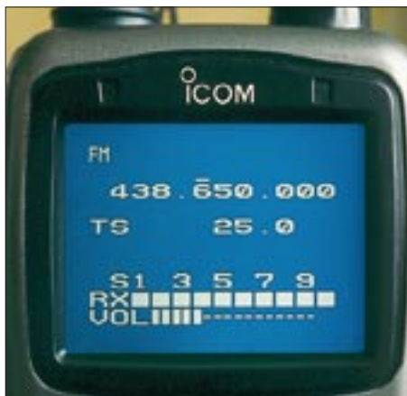
Auf diesem Bildschirm werden zusätzlich Signal- und Lautstärke angegeben.
