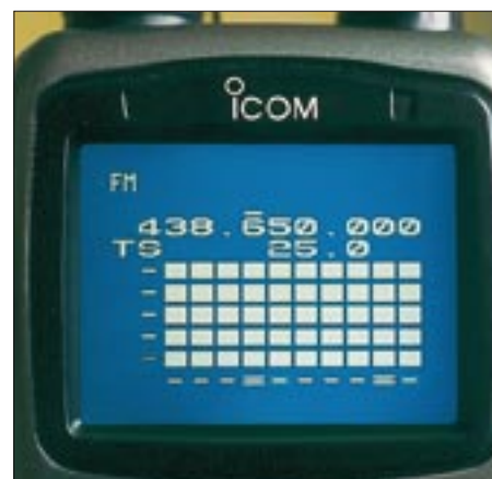
Soll ein Sender aufgespürt werden, mißt der IC-R3 alle 0,3 s die relative Feldstärke. Das Ergebnis wird auf einer Balkenskala dargestellt. Um zu aussagekräftigen Ergebnissen zu kommen, ist die Verwendung einer Richtantenne ratsam.
